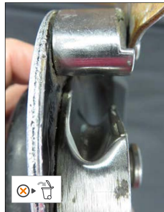
• Žlábek vačky opotřebovaný až po indikátor
