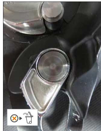
• Deformovaná bezpečnostní západka
