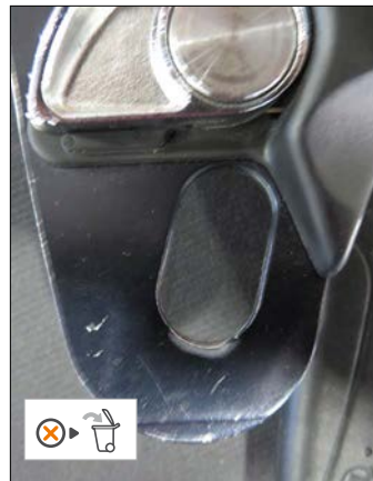
• Připojovací otvor deformovaný rázovým zatížením
